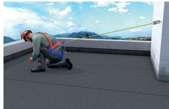
Abbildung 47 - Darstellung eines Rückhaltesystems mit einstellbarem Halteseil, das an einem Einzelanschlagpunkt befestigt ist
