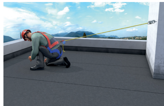
Figure 47 - Schéma d'un système de retenue à longueur réglable, raccordé à un point d'ancrage unique
