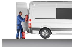
Eingesetzte Feuerlöscher nicht mehr aufhängen und neu füllen lassen
