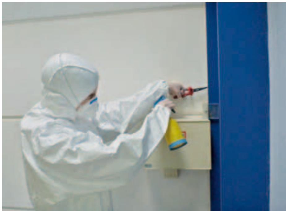
Prise d'échantillons de matériaux
