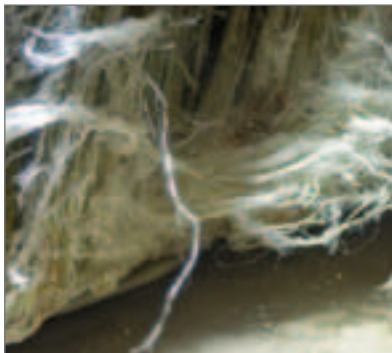
Amiante blanc (chrysotile)
