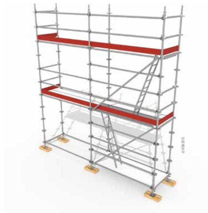
Un échafaudage de pied est une construction provisoire servant de moyen d'accès et/ou de poste de travail en hauteur (p. ex. : travaux de maçonnerie, de façade, de toiture, de peinture, de nettoyage, ...).
