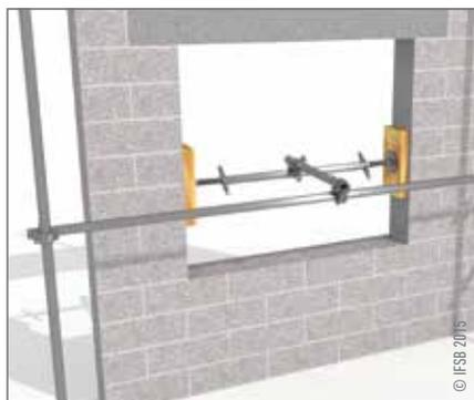
Pour les ancrages par étrépillons, il y a lieu de vérifier la résistance de la surface d'appui ainsi que de resserrer régulièrement les vérins.
