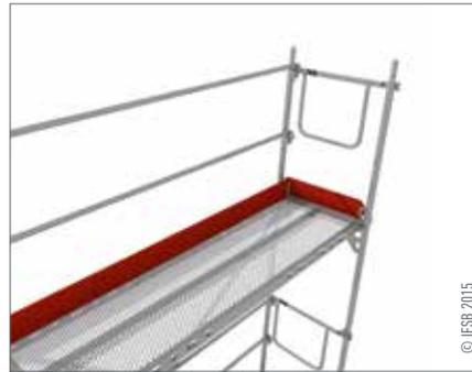
La distance (d) entre les planchers de travail et la façade ne doit pas dépasser 0,30 m. Si cela n'est pas possible, il faut mettre en oeuvre une console de rapprochement ou un garde-corps intérieur complet.
