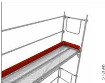
Der Abstand (d) zwischen den Belägen und der Fassade darf höchstens 0,30 m betragen. Sollte dies nicht möglich sein, so ist eine Innenkonsole oder ein vollständiger Innenseitenschutz vorzusehen.
