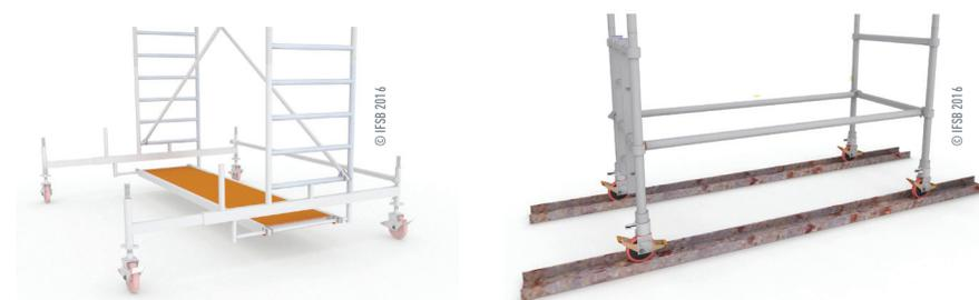
**⚠ Tout échafaudage roulant doit être équipé de roues avec frein.**
