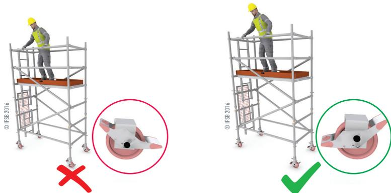
Il est strictement interdit de monter par l'extérieur sur un échafaudage roulant !
