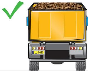
La benne et le hayon arrière doivent être étanches.
