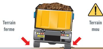
Ne pas benner si la portance du sol est insuffisante et surtout pas si le terrain peut s'affaisser d'un côté.
