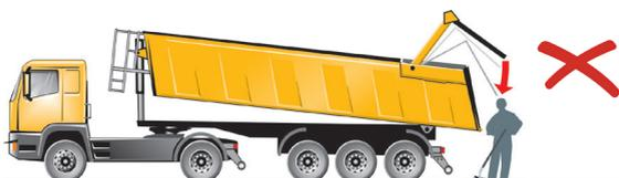
Lors du nettoyage, ne pas se placer sous le hayon hydraulique relevé s'il n'est pas sécurisé par des équipements adaptés ! De l'extérieur, il est difficile de constater si le système hydraulique est équipé d'un dispositif de sécurité qui empêche la fermeture soudaine et imprévisible du hayon hydraulique.
