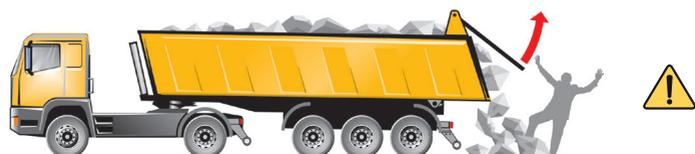
Si le hayon arrière ne s'ouvre pas automatiquement, il faut l'ouvrir manuellement.
