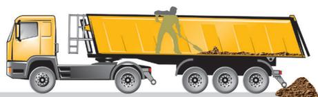
Un nettoyage fréquent de la benne s'impose si le vrac est collant et si le type de chargement change.
