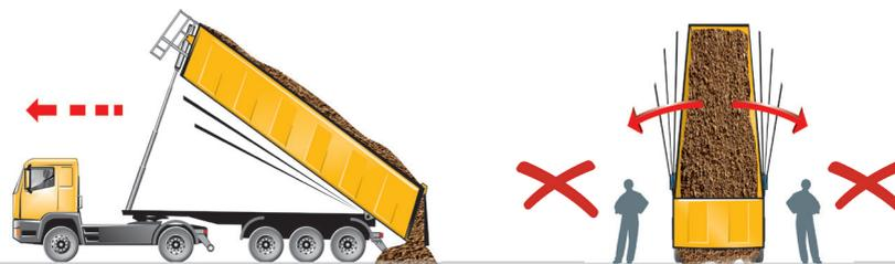
Si les matériaux en vrac doivent être répandus, et que le constructeur du véhicule l'autorise également dans son mode d'emploi, alors **cet épandage doit se faire très lentement et très prudemment** ! Pas de freinage brusque même pas pour décrocher les matériaux qui collent dans la benne ! Cette pratique courante est sans doute la cause la plus fréquente de renversement de véhicules.
