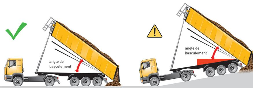
Une pente dans le sens de la marche a pour conséquence que le chargement glisse plus tard. En d'autres termes, il glisse à un angle de basculement plus élevé ou, dans le pire des cas, il ne glissera pas.
