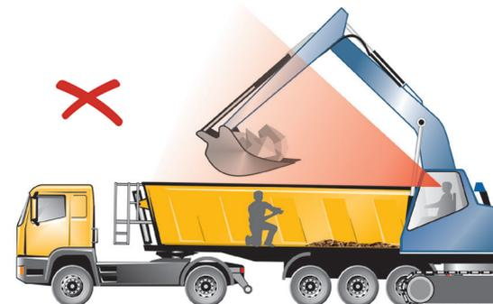
Être prudent lors du nettoyage de la benne. Le machiniste ne voit personne à l'intérieur de la benne. Par conséquent, les travaux de nettoyage ne doivent jamais être effectués dans la zone d'opération des engins de terrassement.
