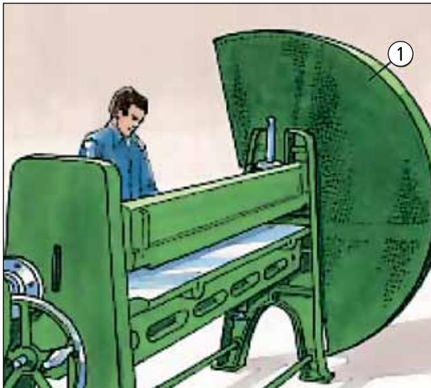
verrouillage et interrupteur
