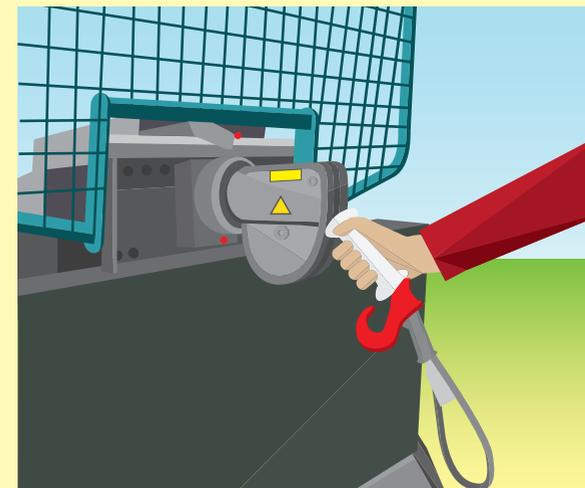
A titre de sécurité supplémentaire, un dispositif anti-contusion au niveau du câble permet de protéger la main contre toute contusion lors de l'enroulement du câble, de même que contre les ruptures de câble éventuelles et le froid en période hivernale.
