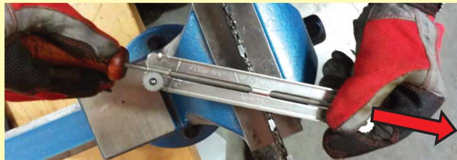
L'aiguisage de la chaîne avec un gabarit de limage facilite le respect de l'angle correct
