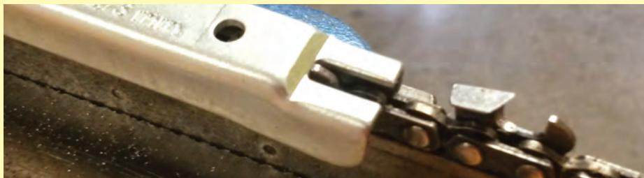
La jauge de limiteur de profondeur indique s'il est nécessaire de limer le limiteur de profondeur et jusqu'à quel niveau
