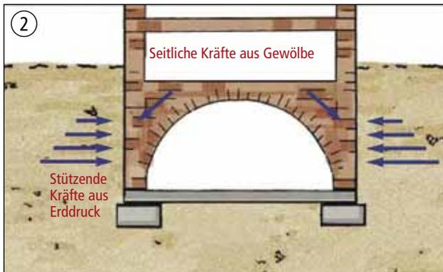
unterkanten, Standsicherheit des Gebäudes, im Baugrund wirkende Kräfte (z. B. waagerechte Krafteinleitung aus Gewölbe- oder Rahmenwirkung) erkunden und prüfen ②.
