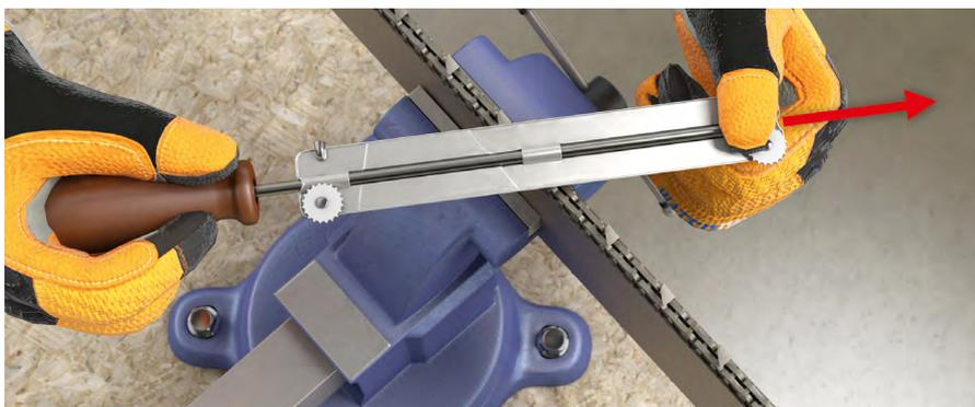
L'aiguisage de la chaîne avec un gabarit de limage facilite le respect de l'angle correct.
