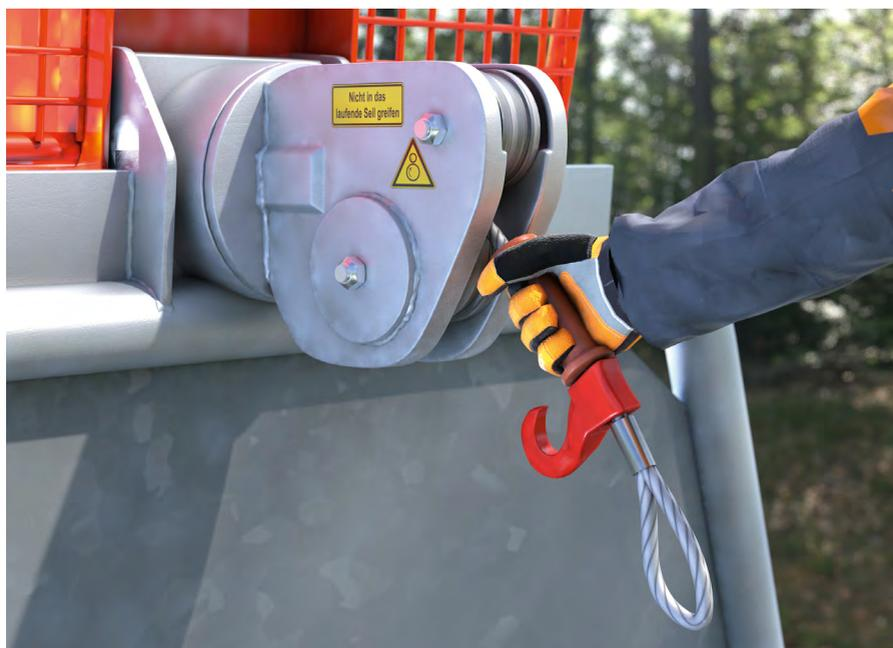
A titre de sécurité supplémentaire, un dispositif anti-contusion au niveau du câble permet de protéger la main contre toute contusion lors de l'enroulement du câble, de même que contre les ruptures de câble éventuelles et le froid en période hivernale.
