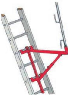
Leitern-Konsolgerüste dürfen nicht als Dachfanggerüste verwendet werden da die Leitern keine dynamischen Kräfte aufnehmen können. Beim Begehen einer Leiter durch eine Person entsteht nur eine geringe Durchbiegung. Stürzt eine Person von einer geneigten Dachfläche auf die Rückenlehne oder Arbeitsplattform, tritt eine hohe Durchbiegung der Leiter auf die zum Bruch der Leiter führen kann und somit zum Einsturz des ganzen Gerüsts.
