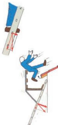
Les échafaudages sur taquets d'échelles ne se prêtent qu'à des travaux de courte durée, p.ex. remplacement ou nettoyage de la gouttière, travaux d'inspection.
