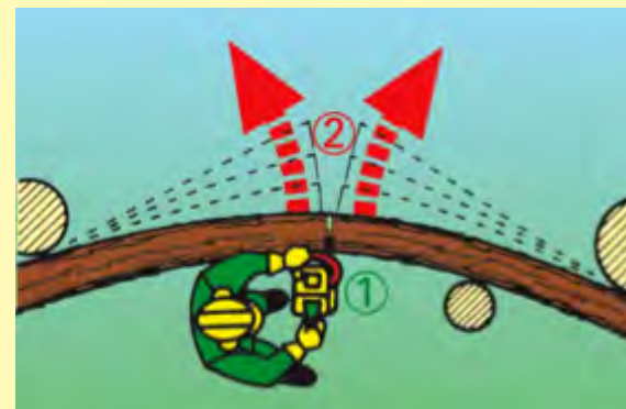
Troncs sous tension sur un côté – le tronc part vers le côté
