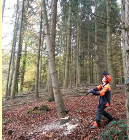
Hängengebliebenen Baum mit dem Fällheber oder Wendehaken abdrehen (dabei den Fällheber/ Wendebaum nur auf Zug bedienen).
